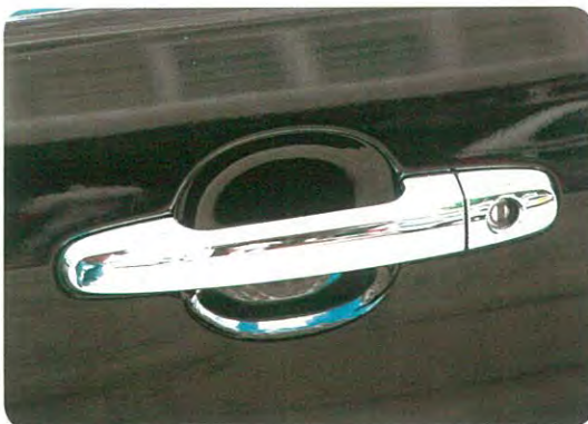
รูปที่ 29 อุปกรณ์ตกแต่งภายนอกรถยนต์ ต้องการพอลิเมอร์ที่มีความแข็งแรงสูง ทนทานต่อแรงกระแทกและรอยขีดข่วนได้ดี
